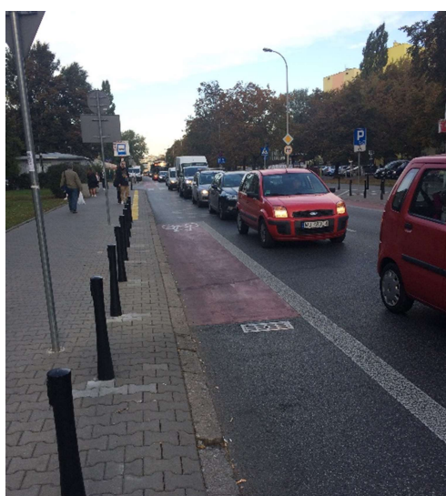
Przejazd rowerowy przez ulicę poprzeczną, zapewniający ciągłość drogi rowerowej
