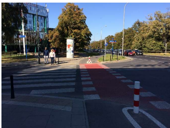
Przejazd rowerowy przez ulicę poprzeczną, zapewniający ciągłość drogi rowerowej
