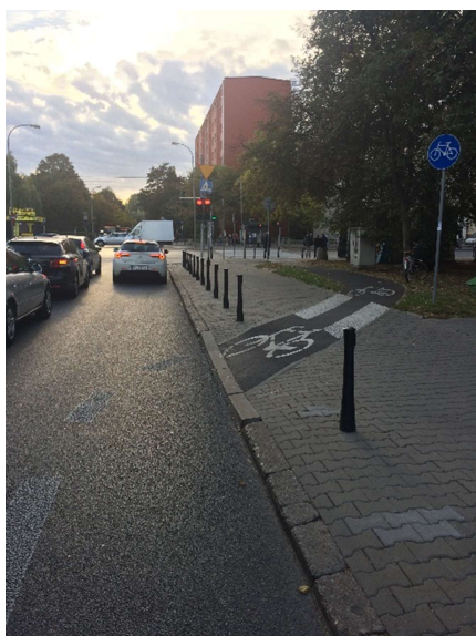
Wyprowadzenie ruchu rowerowego z pasa rowerowego i połączenie z drogą dla rowerów przebiegającą równolegle do jezdni – przykład odcinka jednokierunkowej drogi dla rowerów.
