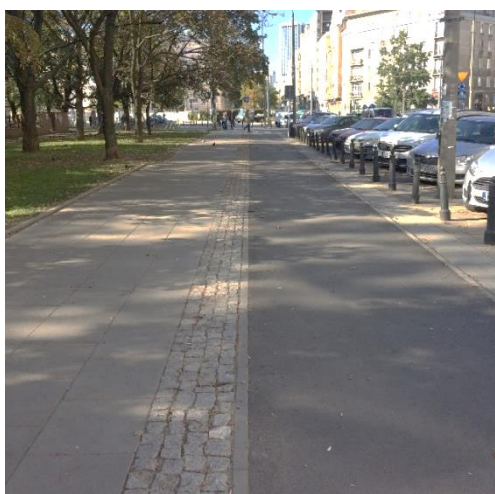
Przykład trasy rowerowej zorganizowanej w formie drogi dla pieszych i rowerów z wyraźnym podziałem na przestrzeń dla pieszych i rowerzystów, oddzielone od siebie buforem (pas z kostki)
