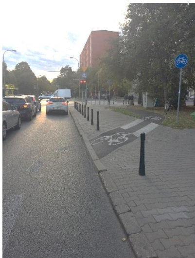
Wyprowadzenie ruchu rowerowego z pasa ruchu dla rowerów na drogę dla rowerów przebiegającą równoległą do jezdni – przykład odcinka jednokierunkowej drogi dla rowerów
