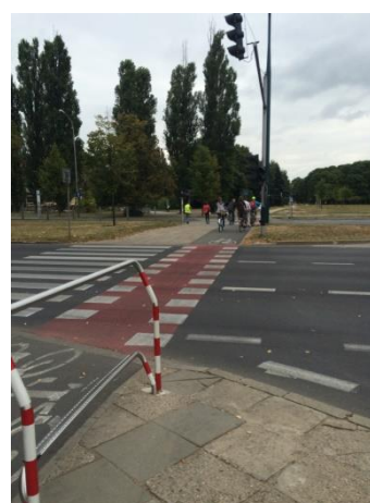
Przykłady przejazdów rowerowych przez ulice poprzeczne i zjazdy wykonane z nawierzchni asfaltowej z zastosowaniem koloru czerwonego (widoczne dla kierujących pojazdami) oraz dostosowane do niwelety drogi dla rowerów. Przykład umieszczenia urządzenia ułatwiającego oczekiwanie na sygnał zielony przy skrzyżowaniu z sygnalizacją świetlną (zdjęcie w dolnym prawym rogu)
