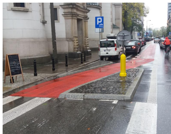
Przykład wyznaczenia kontrapasa rowerowego w obrębie skrzyżowania i przejść dla pieszych z azylem
