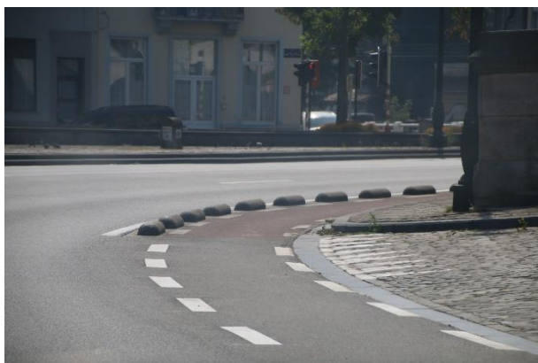
Przykład pasa ruchu dla rowerów z trwałą separacją od ruchu samochodowego
