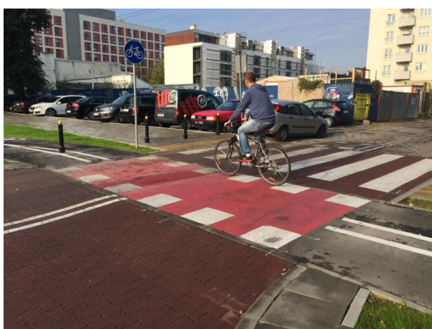
Przykłady przejazdów rowerowych przez ulice poprzeczne i zjazdy wykonane z nawierzchni asfaltowej z zastosowaniem koloru czerwonego (widoczne dla kierujących pojazdami) oraz dostosowane do niwelety drogi dla rowerów. Przykład umieszczenia urządzenia ułatwiającego oczekiwanie na sygnał zielony przy skrzyżowaniu z sygnalizacją świetlną (zdjęcie w dolnym prawym rogu)
