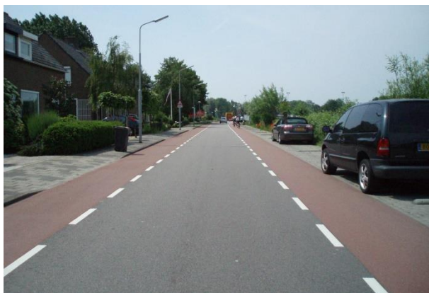
Przykład przekroju „2-1” z jezdnią zawierającą jeden dwukierunkowy pas ruchu samochodowego i obustronne pasy ruchu dla rowerów
