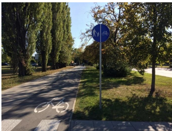
Przykład drogi dla pieszych i rowerów z podziałem na przestrzeń pieszą i rowerową ale bez bufora (rozwiązanie mniej korzystne). Odrębność przestrzeni podkreślona wyłącznie innymi rodzajami nawierzchni
